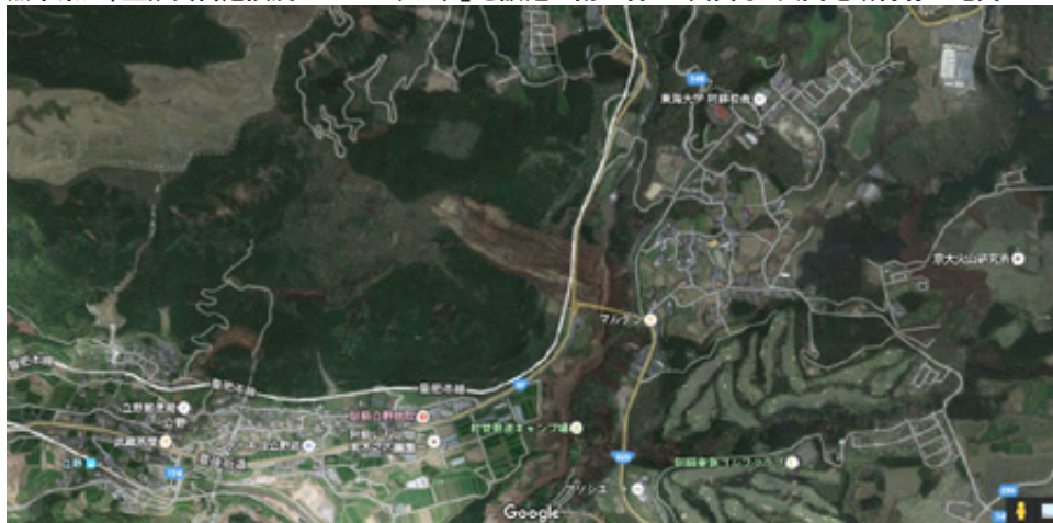
上画像: 阿蘇大橋を落橋させた地すべりが画像中央に見える (Googleマップより)。この調査にあつた防災科学技術研究所は、「崩壊を起こした山は稜線がなだらかであつたにも関わらず、山は崩れ、土砂が橋をのみ込み、その先にある川に流していた。非常に異質な地すべり」と報告している (本文参照 / 画像クリックで拡大表示)
