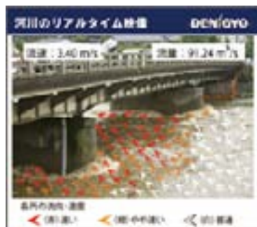
河川監視画像をリアルタイムに解析することで、河川の流速・流量・流向を自動的に表示することができる(日本電業工作株式会社資料より/画像をクリックでリンク)
